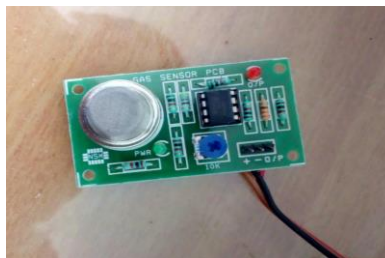
Fig: 2 Gas Sensor
