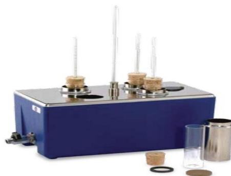
Fig 2. Apparatus for finding the pour and cloud points
