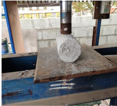
**Fig 4.2 Split Tensile Test**
