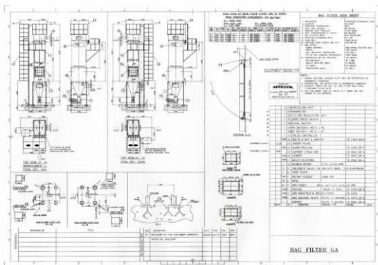
Fig.2 Bag Filter parameter and dimension
