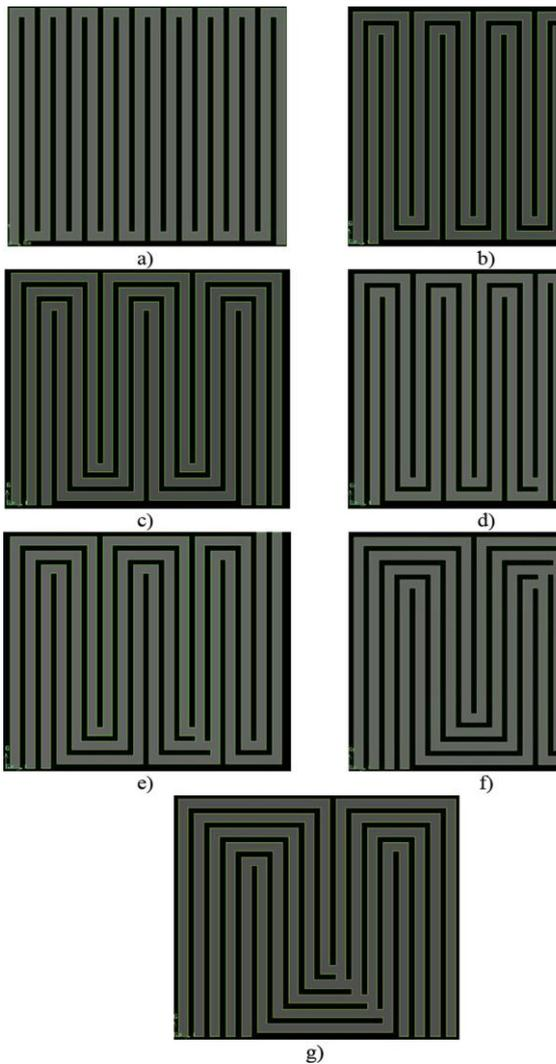
Fig. 5 (a) 1-Serpentine: (b) 2-Serpentine: (c) 3-Serpentine: (d) 2-1-Serpentine: (e) 3-2-Serpentine: (f) 4-3-Serpentine: (g) 5-4-Serpentine. [10]
