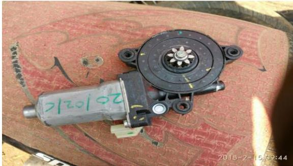
Fig. 1 Worm Gear Motor
