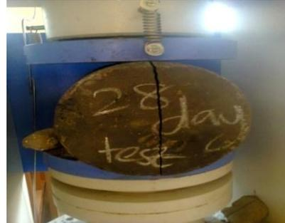
Fig 3 Split Tensile Test
