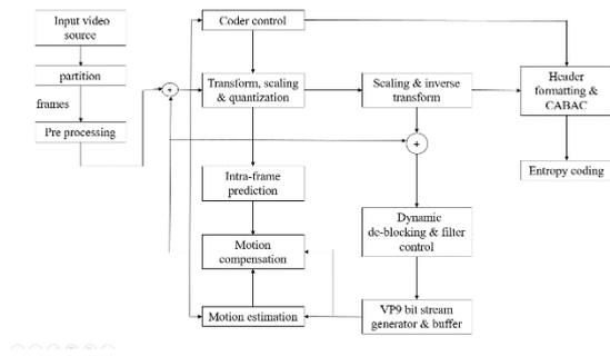
**FIGURE 6.1 BLOCK DIAGRAM OF VP9 ENCODER**
